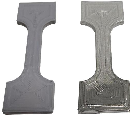
Figure 38 : Éprouvettes épaisses, verte (à gauche) et frittée sans polissage (à droite)
