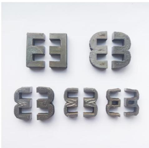
Figure 35 : Passage du noyau optimisé à un composant imprimé
