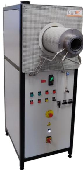
Figure 22 : Four de frittage Pyrox (≈50k€ ; température maxi 1600°C)
