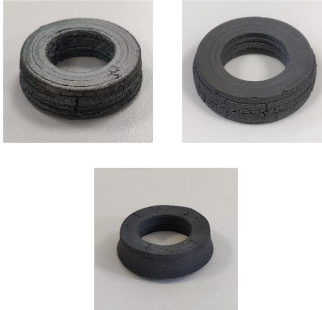
Figure 39 : Apparition de défauts lors du traitement thermique PLA/PVOH/ferrite en haut et résine/ferrite en bas
