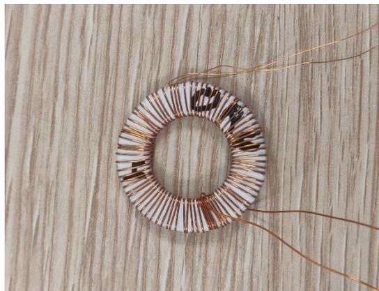
Figure 45 : Tore isolé et bobiné pour la caractérisation magnétique du matériau qui compose son noyau.
