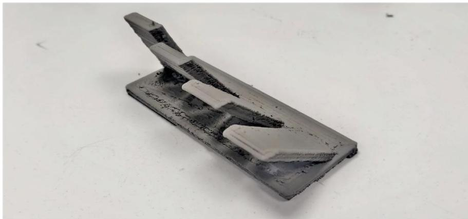
Figure 18 : Pièce de calibration : L'objectif est de trouver les paramètres du procédé d'impression qui permettent de réaliser des éléments en surplomb (20°, 30°, 40°, 50°) sans support.
