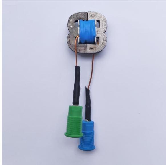
Figure 36 : Noyau optimisé et bobinage
