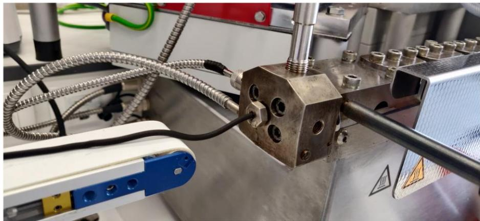
Figure 9 : (a) Extrudeuse bi-vis Process 11
