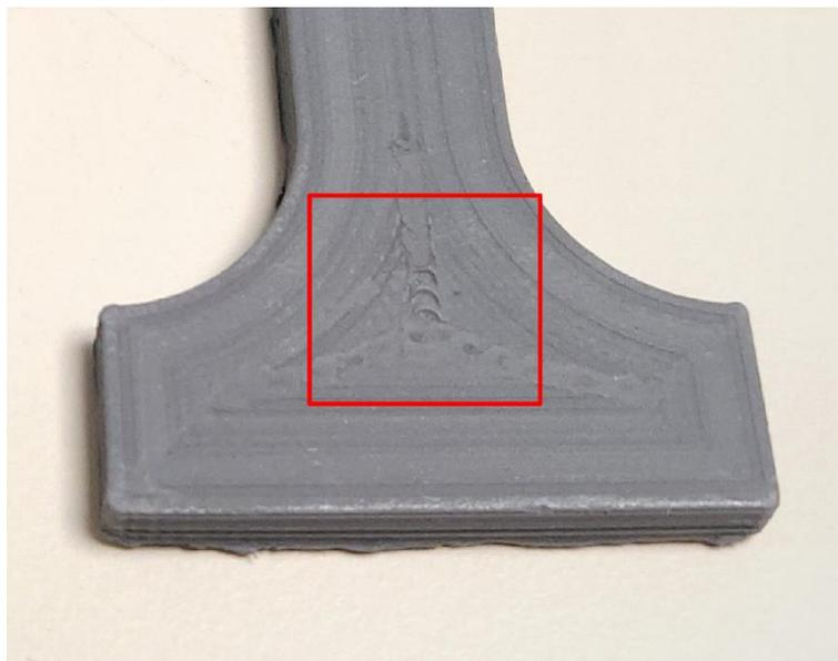
Figure 27 : Défaut de sur-extrusion sur la dernière face d'une impression
