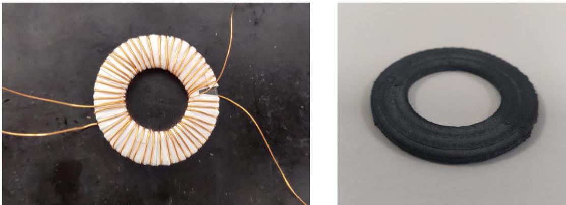
Figure 47 : Tore en ferrite produit par le procédé CIM-like et préparé pour la caractérisation magnétique
