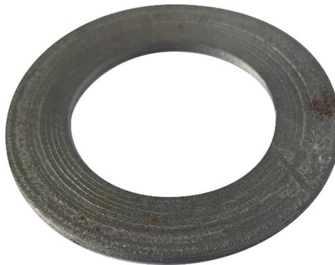
Figure 43 : Tore Fe3%Si imprimé et fritté
