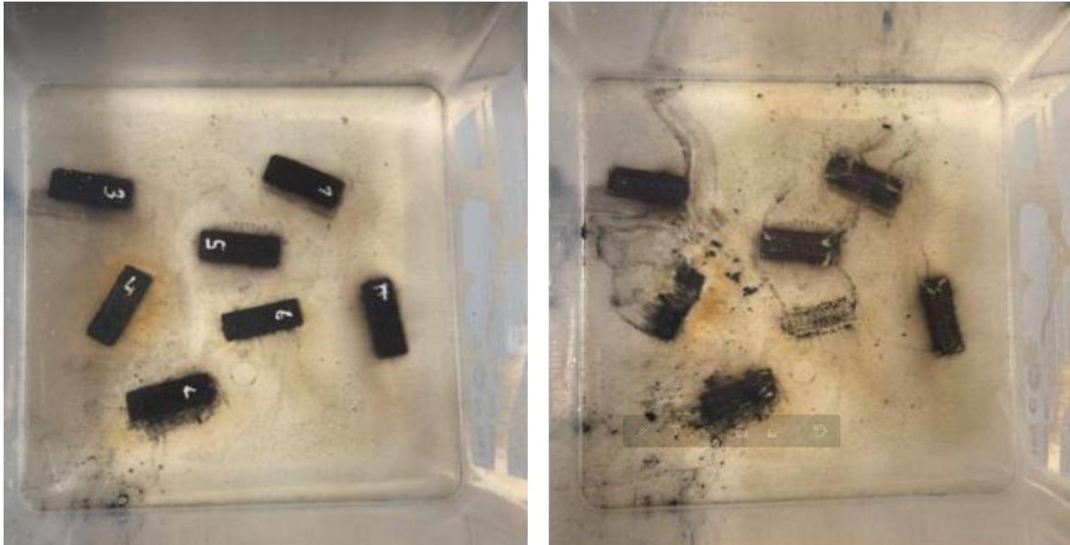
Figure 15 : Résidus de matière après déliantage, visiblement constitués de ferrite
