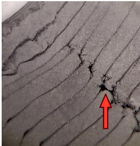
Figure 16 : Défaut de d'impression au niveau du début d'une ligne
