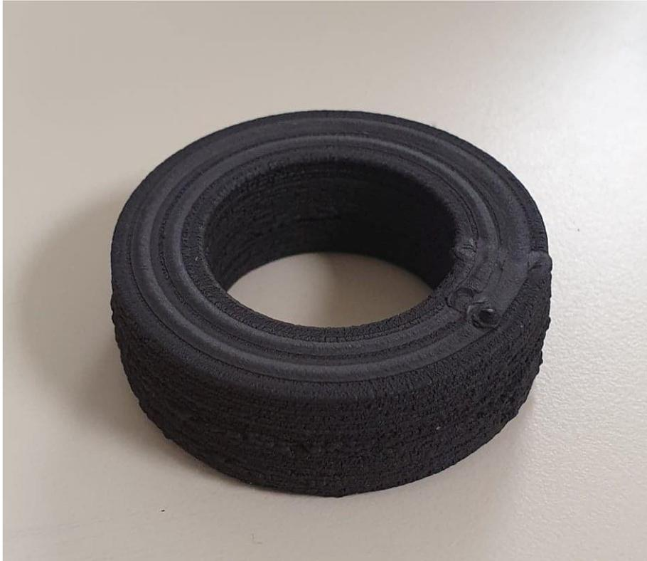
*Figure 17 : Pièce verte imprimée avec une formulation granulée chargé à 40% en ferrite (mélange simple)*
