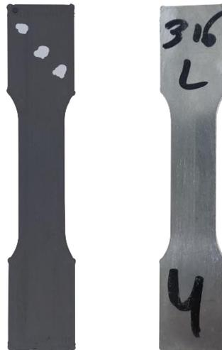
Figure 39 : Éprouvettes fines, verte (à gauche) et frittée après polissage (à droite)
