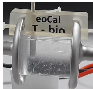
Fig. 4.9: Bulles d'air dans le fantôme de PAA dans la cellule de
