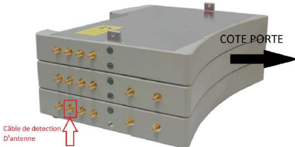
Fig. A.1 : position du câble de détection d'antennes, sous le rack d'amplificateur.
