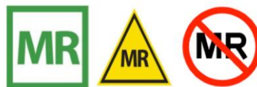
Fig. 1.31 : Marquages associés à un implant passif. D'autres normes ont repris ces sigles identifiables pour d'autres risques que le SAR.
