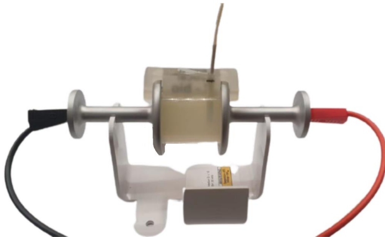
Fig. 4.1: Cellule de calibration des sondes de champ électrique emplies de gel d'agar.
