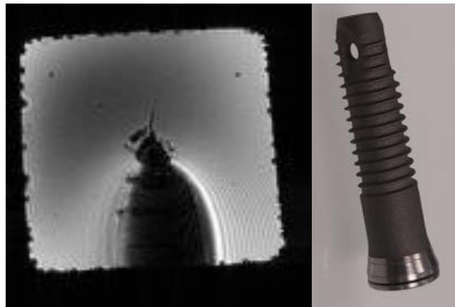
Fig. 4.6: Artefact de susceptibilité induit par l'implant dentaire en titane, de dimensions 12 x 4  $\varnothing$  mm.
