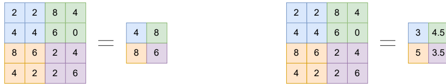
(a) Représentation schématique d’un regroupement par valeur maximale - Maximum Pooling (b) Représentation schématique d’un regroupement par valeur moyenne - Average Pooling
