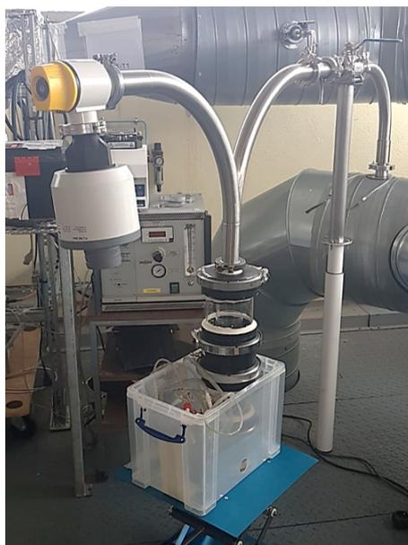
Figure 2.19 – Photographie de la ligne d'injection
