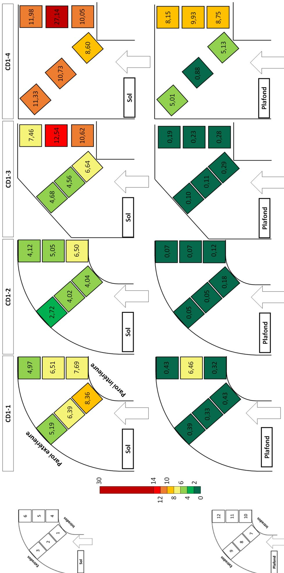
Figure 5.22 – Rapport des concentrations d'aérosol déposées par rapport à la masse d'aérosols injectée (en ppb) dans les quatre coudes d'étude pour les parois du sol et du plafond
