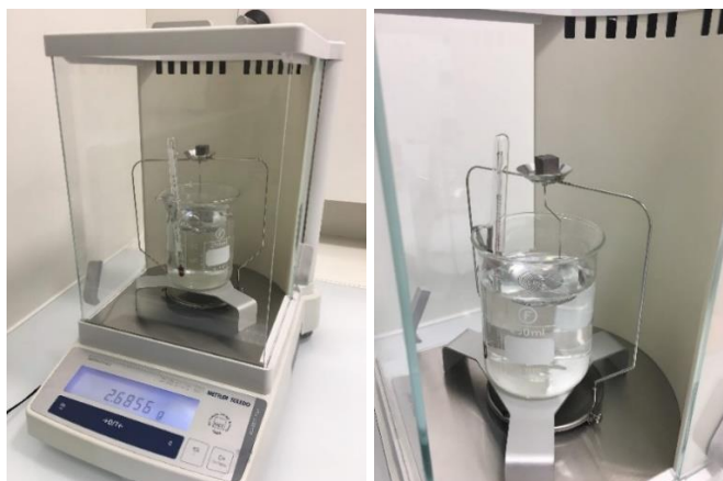
Figure 2.9 – Principe de la mesure de la porosité par pesées successives d'un échantillon dans l'air puis dans l'eau, basé sur la méthode d'Archimède
