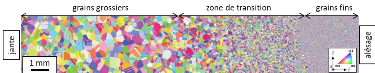
Figure 77 : cartographie EBSD (IPF codée selon \gamma ) mettant en évidence un gradient de taille de grains dans une ébauche de disque [Taboada Michel et al. 2016]
