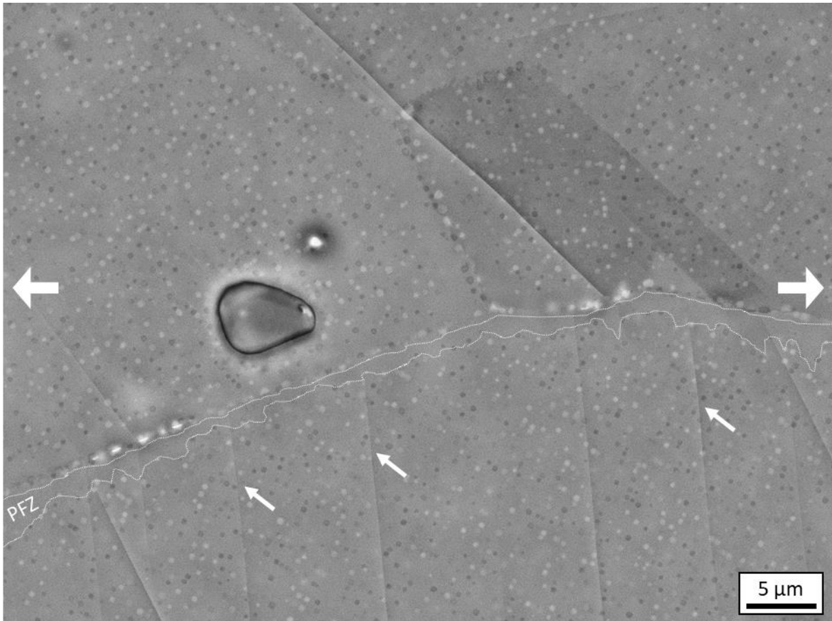
Figure 33 : bandes de glissements aux abords d'un joint de grains après application de 600 MPa en traction et déchargement pour l'éprouvette MS2_4
