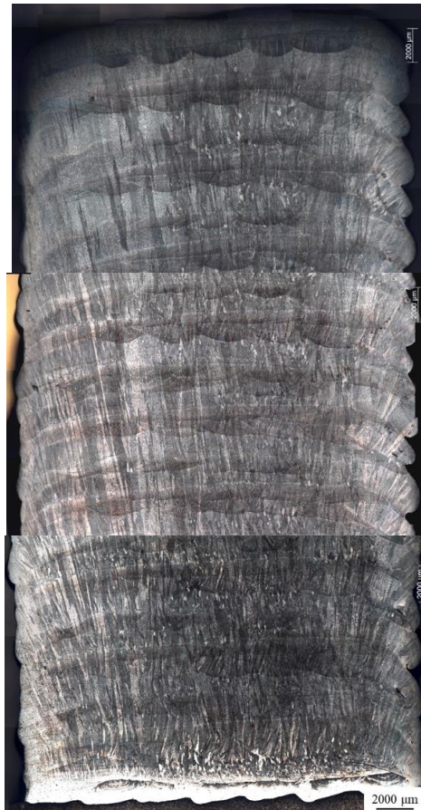
Figure 3-38 : Images en microscopie optique de la section transversale du dépôt Laser/Poudre.
