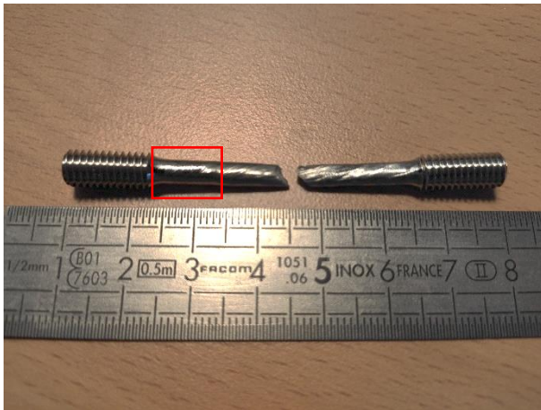
Figure 6-20 : Éprouvettes de traction de la jonction Hybride, amenées à rupture : a) Verticale ; b) 45°.
