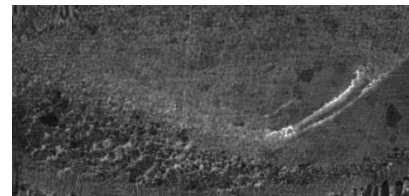
Figure 3-15 : a) Vue schématique de l'écoulement dans le bain liquide lors de la pulsation ; b) Morphologie de la zone de mésoségrégation ; c) Zoom sur la mésoségrégation.
