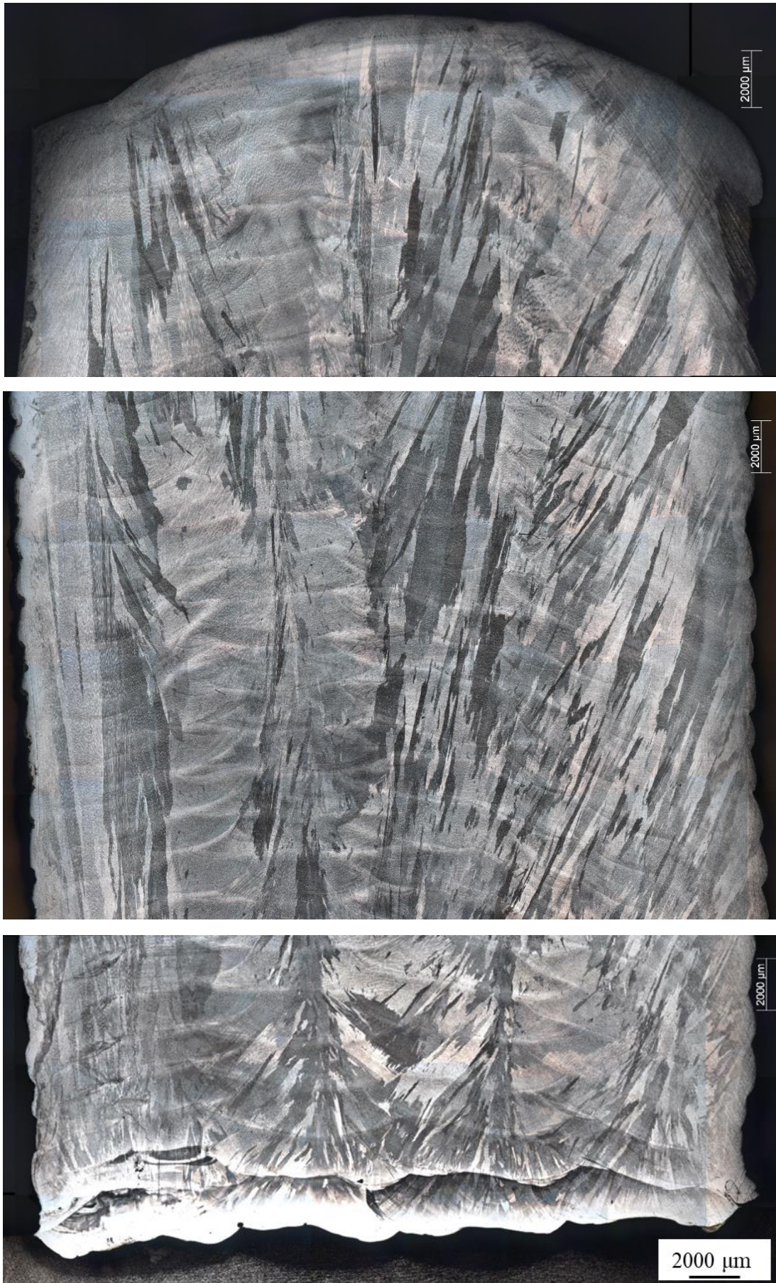
Figure 3-30 : Images en microscopie optique de la section transversale du dépôt Laser/Fil.
