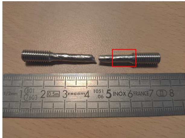
Figure 6-20 : Éprouvettes de traction de la jonction Hybride, amenées à rupture : a) Verticale ; b) 45°.
