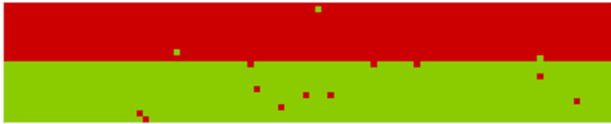
FIGURE 3.11 – Cartographie de phase après indexation CHORD avec une base 6M Al et 6M Si sur la série virtuelle pour des conditions de 7kV 10°. La phase d'aluminium correspond au rouge et la phase de silicium au vert.
