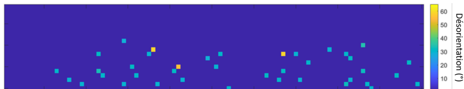
FIGURE 3.13 – Cartographie de désorientation entre les orientations de références et les orientations issues de l’indexation avec des bases de 6 millions de profils Al, 6 millions de profils Si, de la série virtuelle bruitée
