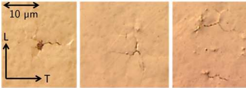
Figure IV.2 : Amorces de fissures observées au microscope optique, pour l'éprouvette A2L1-17 (gauche), A2L1-21 (milieu) et A2L1-26 (droite).
