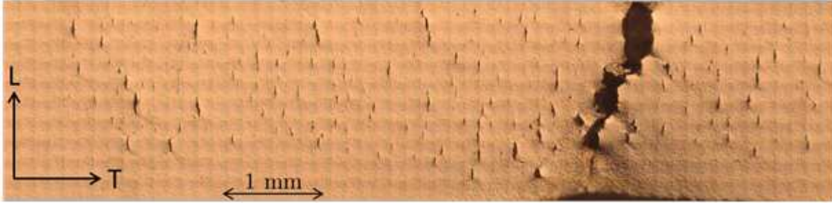
Figure IV.8 : Cartographie de l'éprouvette A2T1-77 ( 10^{-4} \text{ s}^{-1} , 10^{-3} \text{ g}\cdot\text{g}^{-1} , 6.6%). 560 images au grossissement x500 ont été utilisées. L'image originale a une résolution de 6900x25000 pixels.
