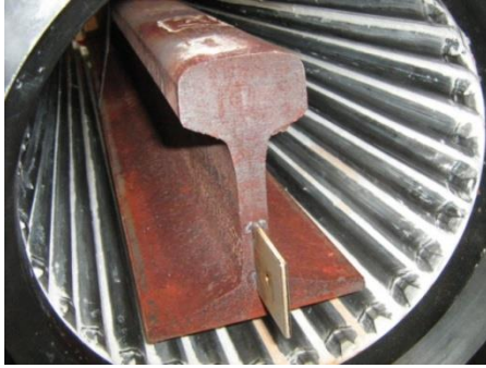
Figure 1.6: Chauffage de rail par inducteur haut flux à 800Hz (Fives Celes)
