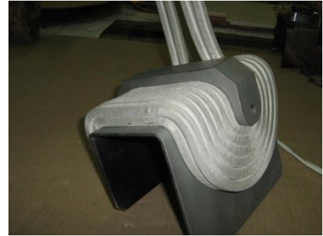
Figure 1.7: Inducteur enveloppant en cours de fabrication (Fives Celes)
