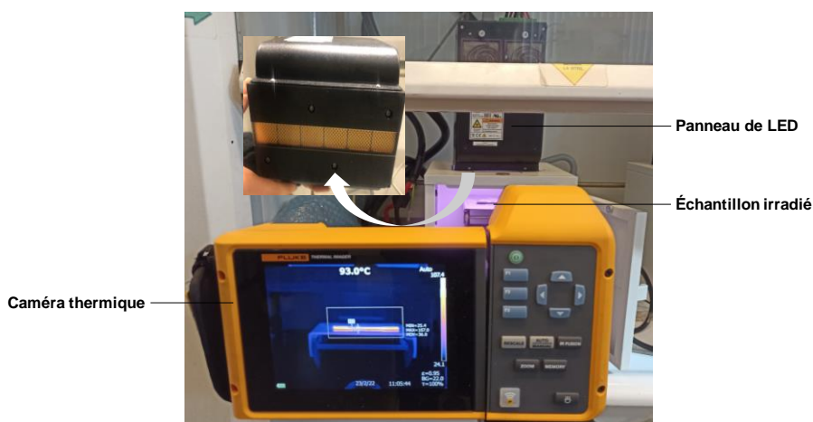
Figure 4. Montage expérimental de l'irradiation d'un échantillon par un panneau de LED à 810 nm suivi par caméra thermique.
