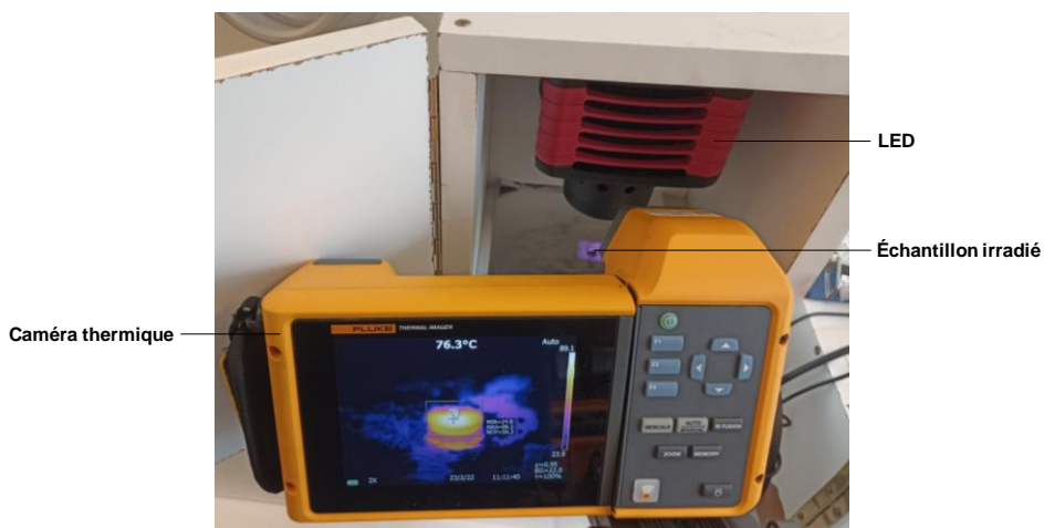
Figure 3. Montage expérimental de l'irradiation d'un échantillon par une LED à 850 nm suivi par caméra thermique.
