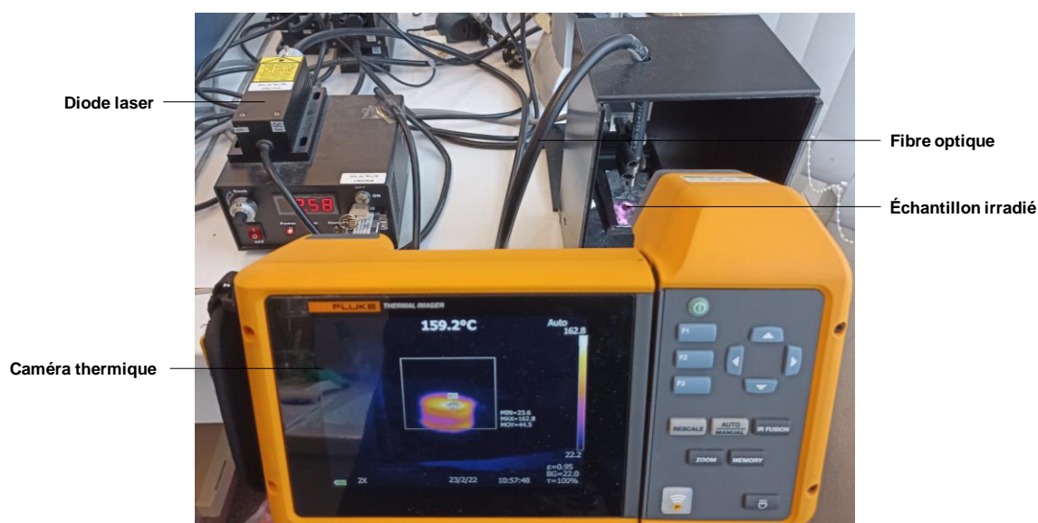
Figure 2. Montage expérimental de l'irradiation d'un échantillon par une diode laser suivie par caméra thermique.
