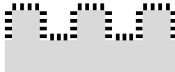
Figure 1.34 Illustration de la surface présentant une double échelle de rugosité prise en compte dans l'étude de N. A. Patankar [76].
