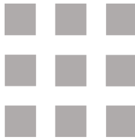
Figure 2.6 Vue du dessus du réseau carré de plots micrométriques. Le sommet des plots est visible en gris. Le schéma n'est pas à l'échelle des dimensions précisées précédemment.
