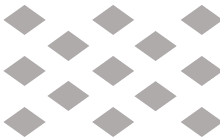
Figure 2.7 Vue du dessus du réseau hexagonal de plots micrométriques. Le sommet des plots est visible en gris. Le schéma n'est pas à l'échelle des dimensions précisées précédemment.
