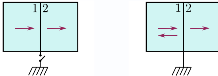
FIGURE 1.14 – Comportement d'une onde incidente se propageant dans un empilement d'éléments piézoélectriques. Le schéma de gauche représente une condition de potentiel flottant à l'interface, et le schéma de droite représente une condition de mise à la masse à l'interface.
