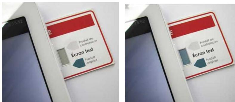
**Figure 4.** Changement de couleur via une antenne Wi-Fi du dispositif anti-contrefaçon réalisé en 2016.
