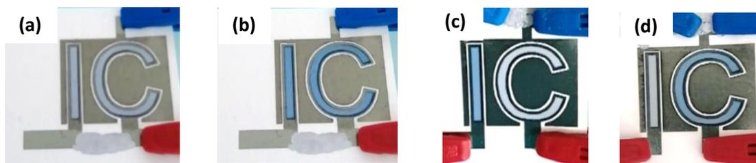
**Figure 3.27.** Prototype fabriqué en jet d'encre avec (a) l'état initial ( $E = 0\text{ V}$ ). (b) Le changement de couleur sur l'ensemble de la surface électrochrome ( $E = -1\text{ V}$ ). (c) Le changement de couleur sur une partie de la surface électrochrome ( $E = -1\text{ V}$ ) et (d) sur l'autre partie de la surface électrochrome ( $E = -1\text{ V}$ ).
