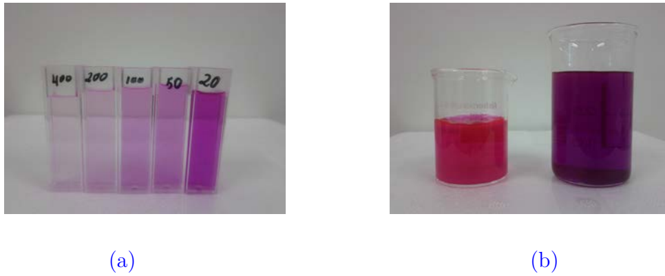
FIGURE 2.18: (a) Éprouvettes d'étalonnage, (b) Solutions de Rhodamine dans l'eau (à gauche) et dans le KSCN (à droite).
