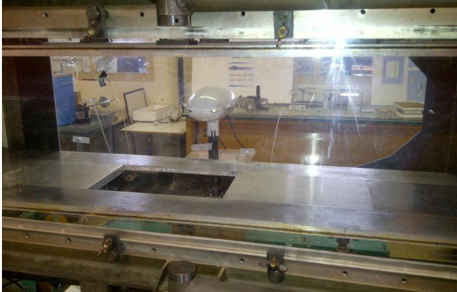
Figure 4.9 - Prototype en cours de test sur soufflerie.
