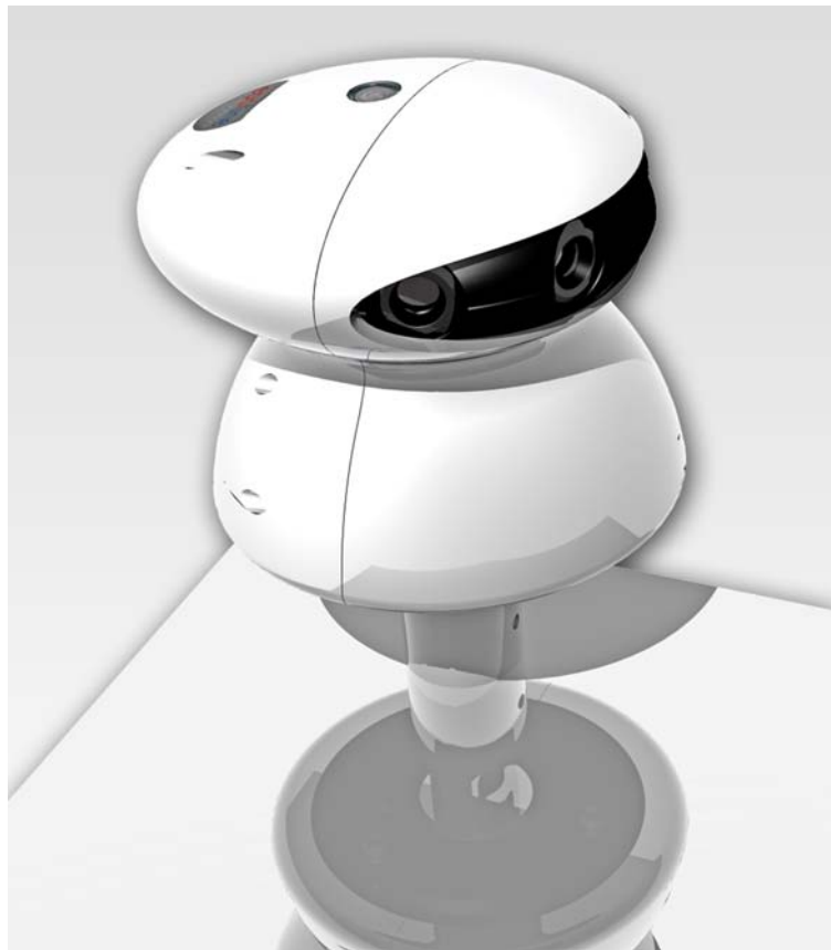
Figure 1.10 - Infographie du prototype d'anémomètre optique développé lors de ma thèse. Ph. Epsiline.
