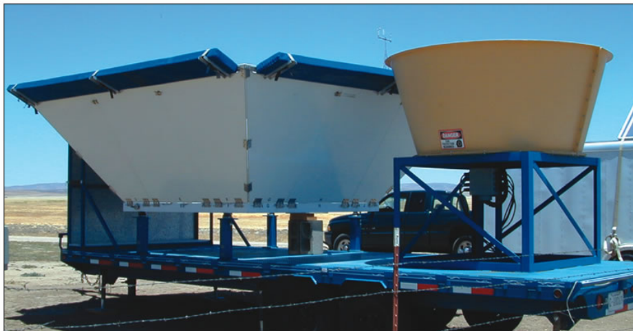
Figure 1.7 - Sodar mobile monté sur une remorque. Ph. U.S. national oceanic and atmospheric administration.
