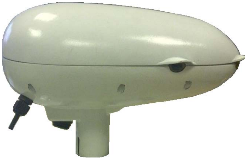
Figure 4.6 - Boîtier utilisé pour les essais en soufflerie et en extérieur.
