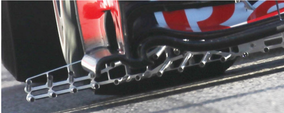
Figure 1.3 - Sondes de Pitot placées derrière l'aile d'une voiture de type formule 1 pour en tester le fonctionnement en conditions réelles. Ph. Racecar Engineering.
