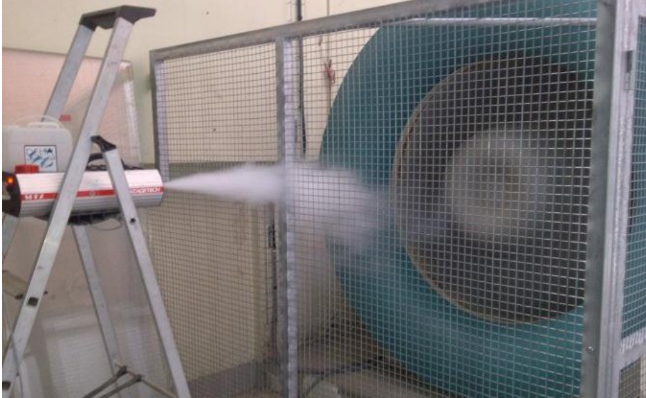
Figure 4.8 - Ensemencement de la veine à l'aide d'une machine à fumée
