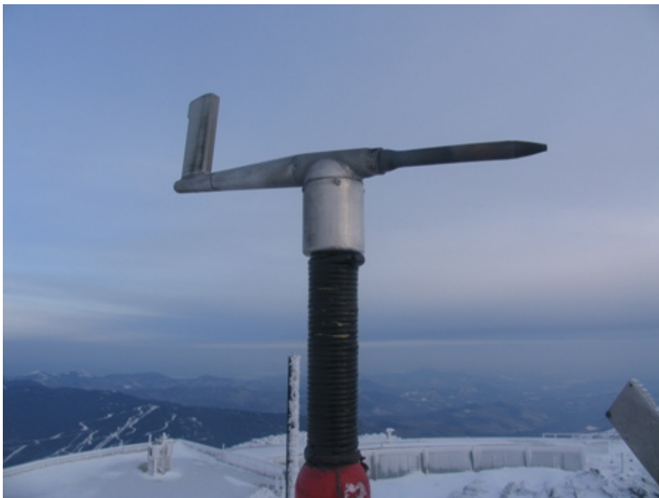
Figure 1.4 - Sonde de pitot montée sur la tête d'une girouette à la station météorologique du mont Washington (États-Unis). Ph. Brian Clark [8].
