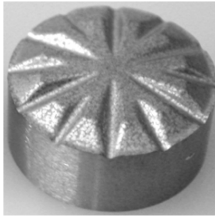
FIGURE 2.2.9 – Design d'interface PDC/WC-Co des taillants de l'étude.
