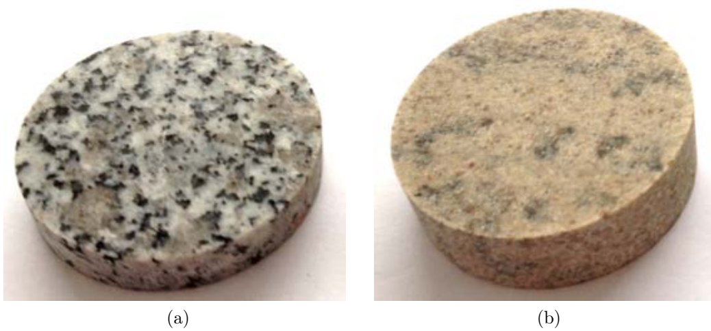
FIGURE 3.1.17 – Photographies des contrefaces rocheuses : a - granite ; b - grès.
