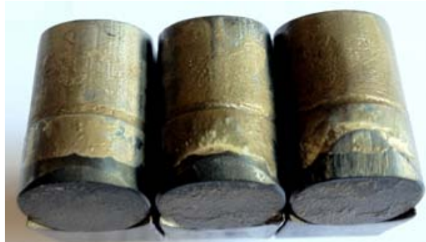
FIGURE 3.2.1 – Photographie vue de dessus de trois taillants de référence brasés dans leur porte-échantillons avec trois états d’usure différents.
