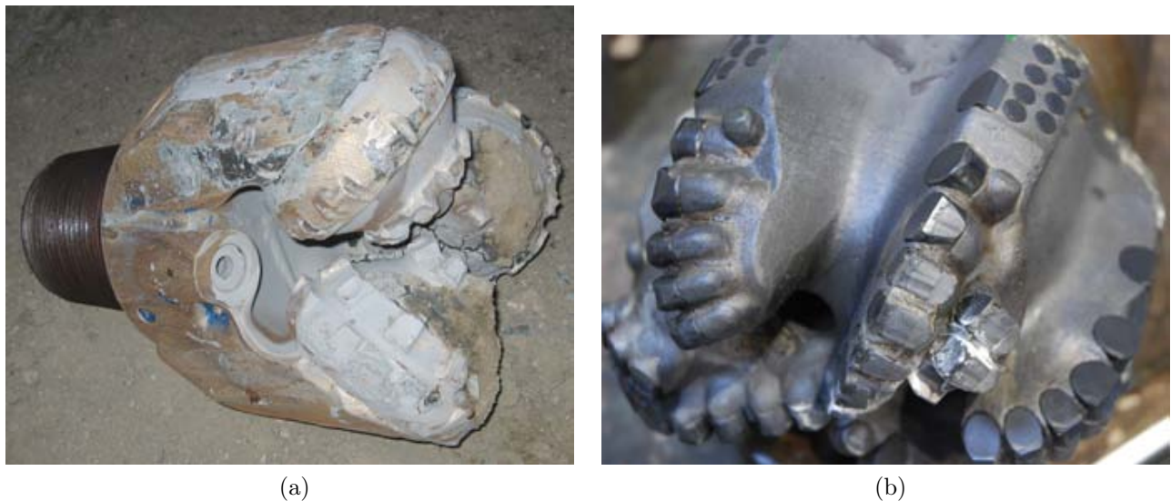
FIGURE 0.0.9 – Photographies d'outils endommagés : a - outil tricône avec dents détruites [USG 2005] ; b - outil PDC avec taillants usés.
