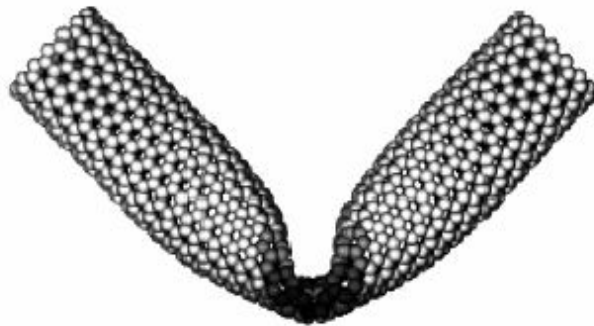
Figure 1.2 : Contrainte mécanique qui induit une flexion dans un nanotube de carbone.
