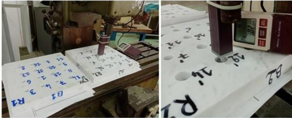
Figure 49 : Mesure de la rugosité avec un rugosimètre SurfTest SJ-201P
