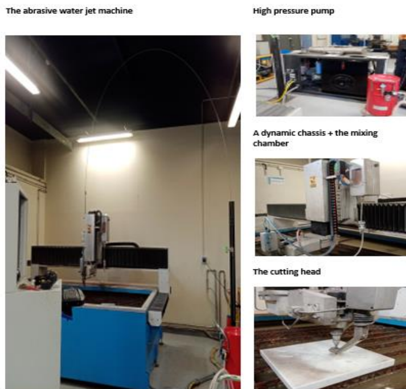
Figure 46 : Machine PTV-CNC pour la découpe à jet d'eau à haute pression
