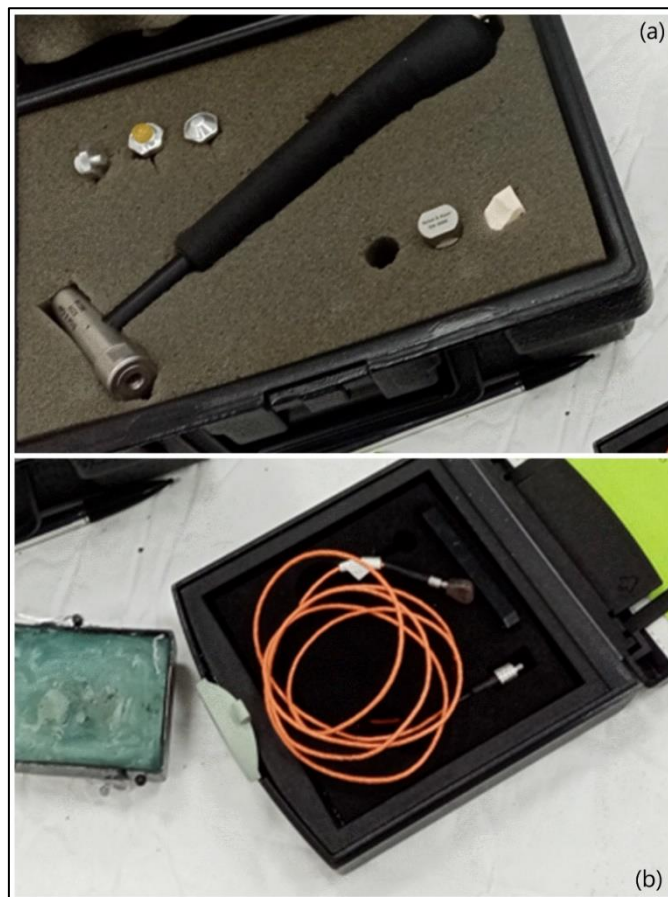
Figure 4 : (a) Marteau (Brüel & Kjær - B&K) de type 8206 ; (b) Accéléromètre (Brüel & Kjaer) de type 4517
