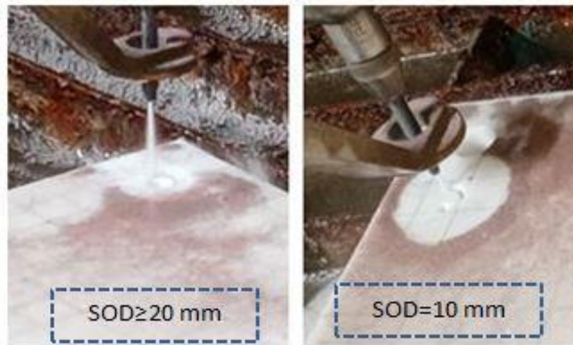
Figure 47 : Tests primaires de la variation de la distance de tir (DT)
