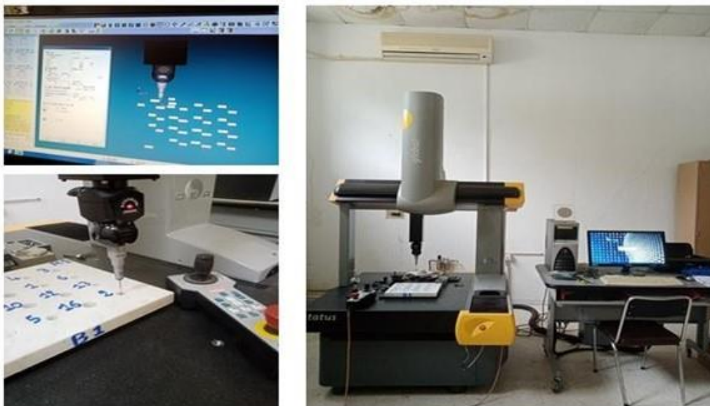
Figure 51 : Machine de mesurer tridimensionnelle (MMT) (MMT à cinq axes ; MMT Brown & Sharpe Global Status 9128 5PDEA).
