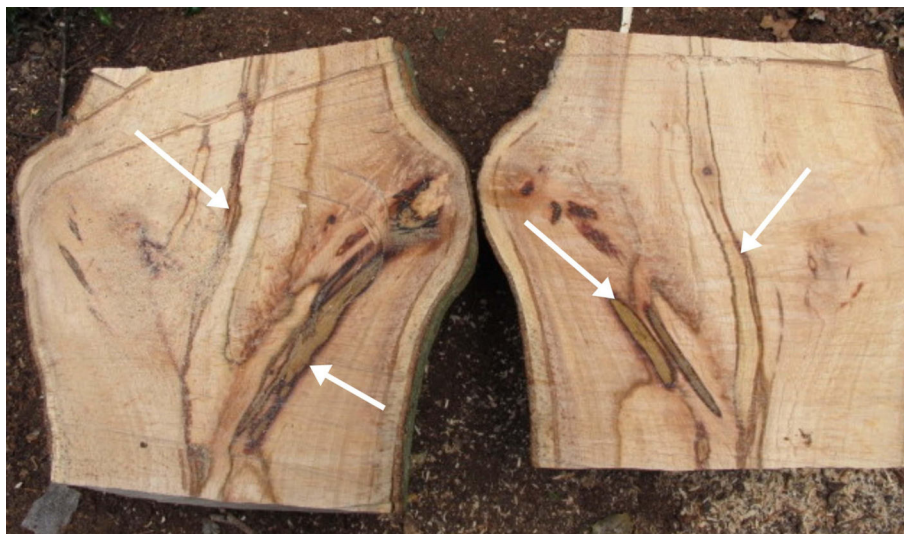
FIG. 1.9 – Tronc de hêtre sectionné, laissant paraître des zones plus foncées (flèches) où la dégradation de la lignine notamment a été initiée [16].
