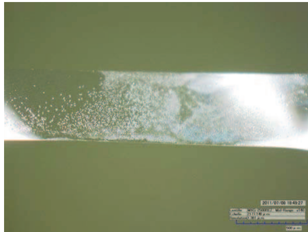
(a) \varepsilon = 0\% : éprouvette plissée à cause des contraintes internes.
