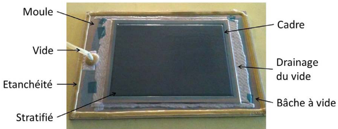
FIGURE 4.3.3: Réalisation d'une plaque de carbone/epoxy avec particules de cuivre par le procédé pré-imprégné
