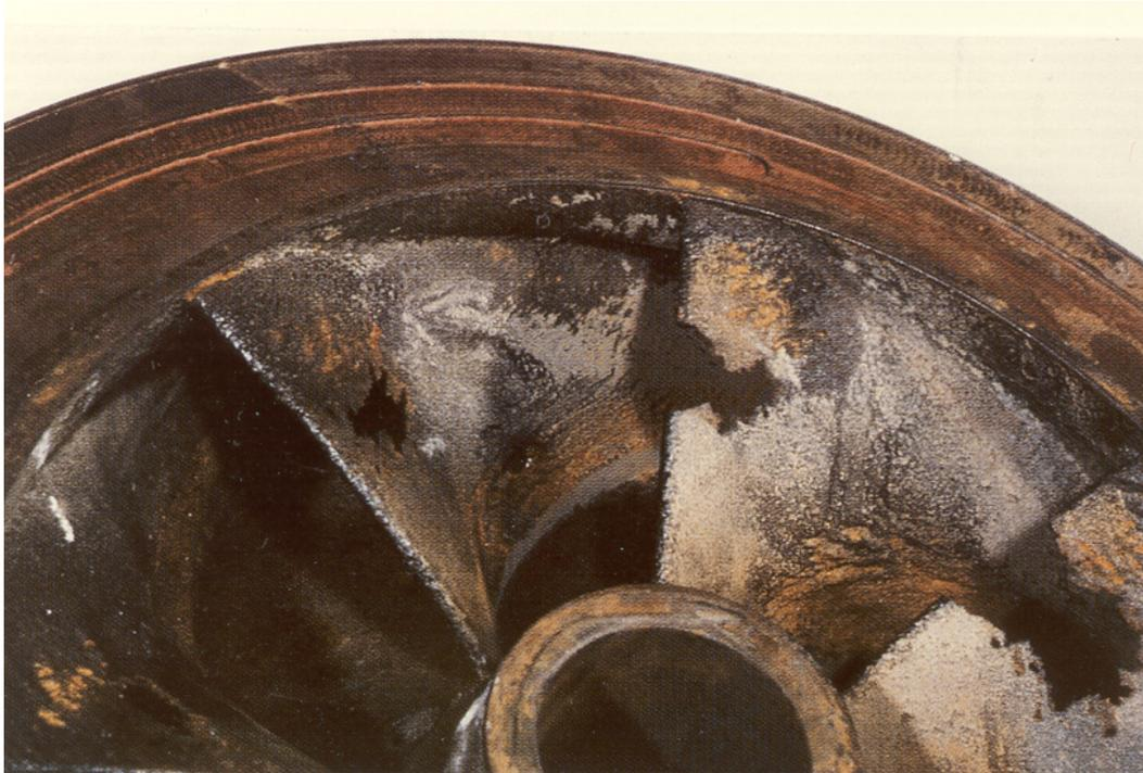
FIGURE 1.2 – Exemple d'érosion d'une roue de pompe [EDF R&D].
