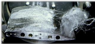
Cavitation sur l'extrados d'un hydrofoile
