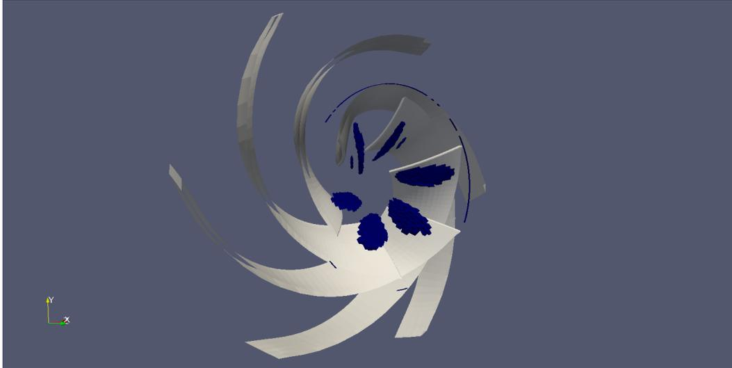
FIGURE B.15 – Surface des aubes en blanc, les zones où le fluide est sous la pression de saturation sont mises en évidence en bleu.
