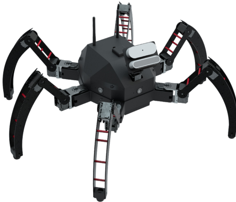
FIGURE 5.45 – ArIA INSPECTOR, le robot hexapode développé par Pilgrim Technology
