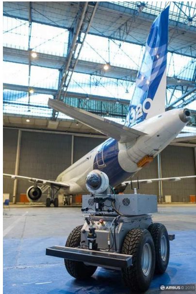
FIGURE 1.1 – Air-Cobot (Aircraft enhanced Inspection by smaRt Collaborative rOBOT), a été développé pour contrôler la qualité des différentes pièces aéronautiques par des contrôles non-destructifs [1].
