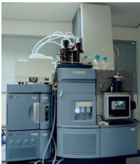
Figure 32- Système Acquity UPLC H-Class (Waters, Milford, USA) couplé au spectromètre de masse Xevo G2 S Q-TOF, présent sur la plateforme d'Analyse Haute Résolution de Biomolécules du laboratoire LIENSs
