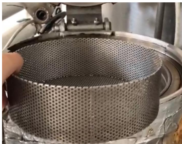
Figure 18- Photo du panier métallique perforé de la DIC
