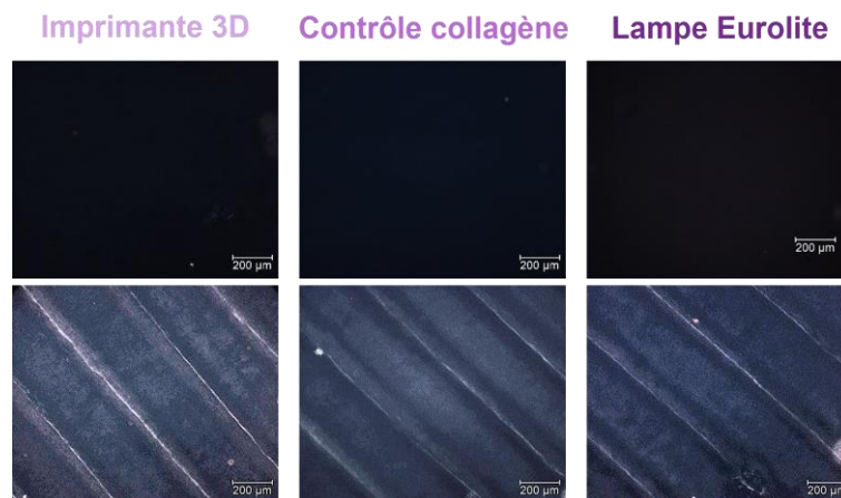
Figure 116 : Observation sous polariseurs croisés de l'alignement du collagène dans les hydrogels réticulés avec le module LED de l'imprimante 3D (gauche), les contrôles de collagène (milieu) et les hydrogels réticulés avec la lampe Eurolite (droite) quels que soient les temps d'imprégnation et de réticulation.
