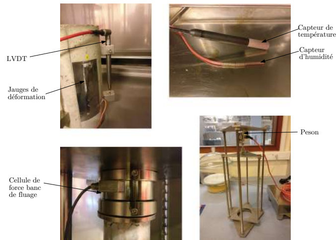
FIGURE 3.11. – Instrumentation des éprouvettes de la campagne d'essais sur corps d'épreuve après cure endogène de 3 mois et système de contrôle des conditions THM appliquées
