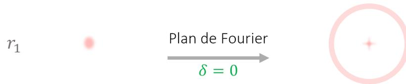
FIG. II.18 Le diagramme de rayonnement d'un nanocristal unique à une position  $r_1$ , dans le cas où la caméra est positionnée exactement sur le plan de Fourier ( $\delta = 0$ ), est un cercle centré en  $r_2$ .
