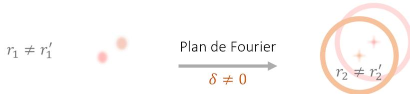
FIG. II.20 Le quasi-diagramme de rayonnement de deux nanocristaux à une position respectivement  $r_1$  et  $r_1'$ , dans le cas où la caméra est positionnée à une distance  $\delta$  du plan de Fourier, est deux cercles centrés en respectivement  $r_2$  et  $r_2'$ .
