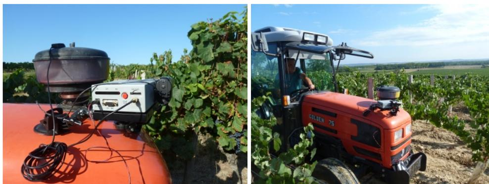
FIGURE 4.8 – Images du dispositif de prises de vues pour l'acquisition des vidéos dans les parcelles de vignes. Le boîtier gris est la caméra *Imajbox* et sur sa droite, une caméra *Contour*, toutes deux prêtées par la société *Imajing*.
