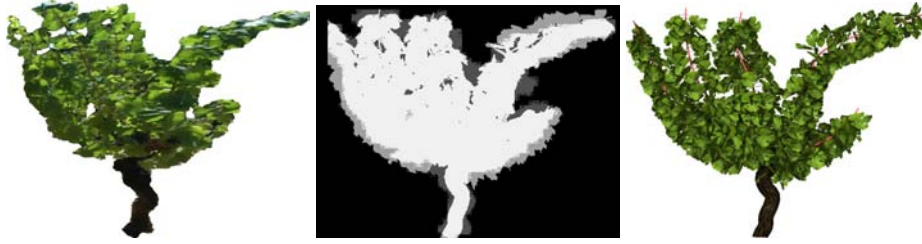
FIGURE 3.11 – À gauche, l'image originale d'un pied de vigne. À droite, la projection d'un modèle 3D reconstruit grâce à notre méthode. Au milieu la carte d'erreurs entre l'image de gauche et l'image de droite. Les pixels en gris correspondent aux pixels où les deux images ne se superposent pas.
