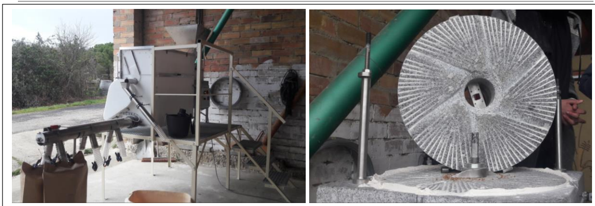
Photographie 1. À gauche, moulin type Astrié monté sur un échafaudage ergonomique et équipé d'une vis de distribution automatique. À droite, meule de 50cm, la meule tournante a été soulevée, vue sur les stries permettant le "déroulement" du grain
