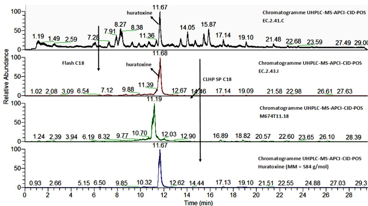
Figure 45: Chromatogrammes UHPLC-MS-APCI-CID-POS de la fraction EC.2.41.C, EC.2.43. I, de la huratoxine et de la molécule M674T11.18
