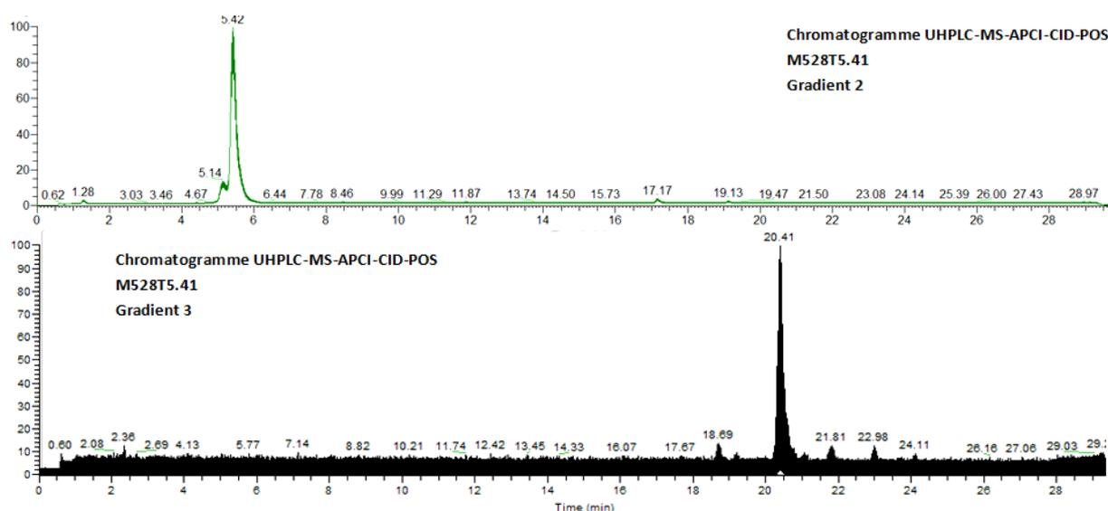
Figure 122: Chromatogrammes UHPLC-MS des molécule M528T3.41 avec le gradient 2 et le gradient optimisé 3
