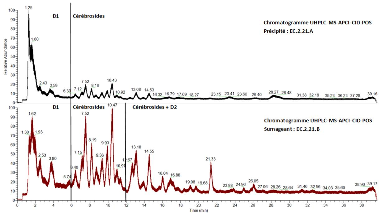
Figure 37: Chromatogrammes UHPLC-MS-APCI-CID-POS du précipité et du surnageant
