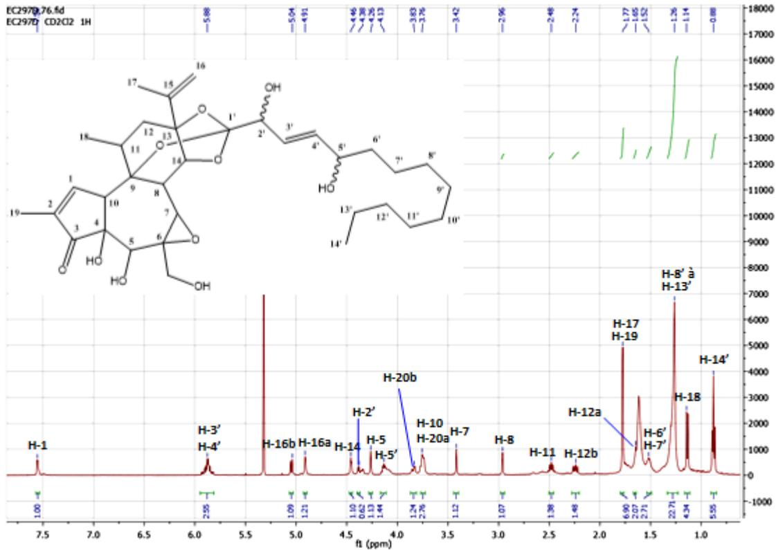
Figure 102: Spectre de RMN <sup>1</sup>H de la molécule M618T2.82 dans du CD<sub>2</sub>Cl<sub>2</sub>
