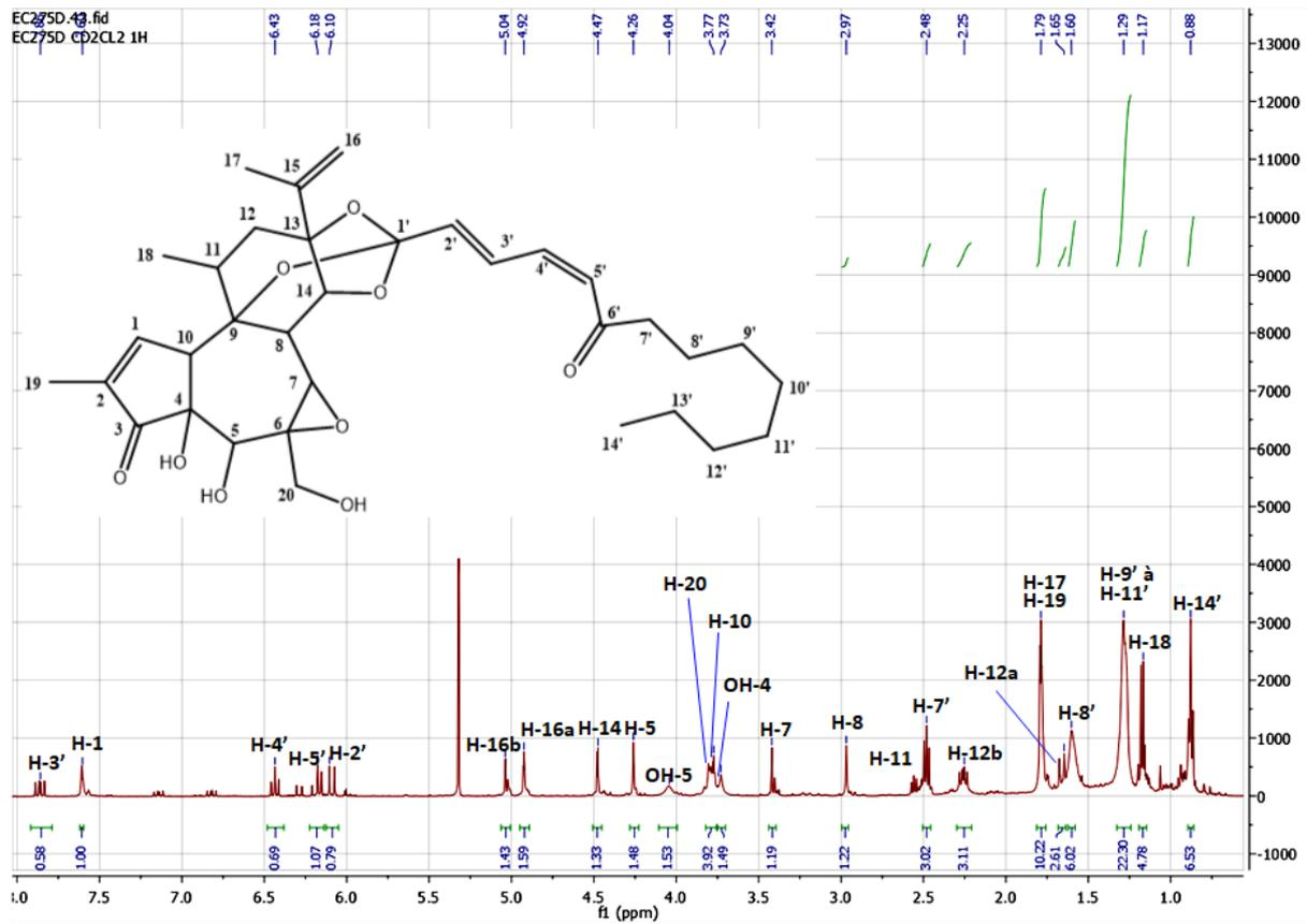
Figure 75: Spectre de RMN  $^1\text{H}$  de la molécule M598T6.37 dans le  $\text{CD}_2\text{Cl}_2$
