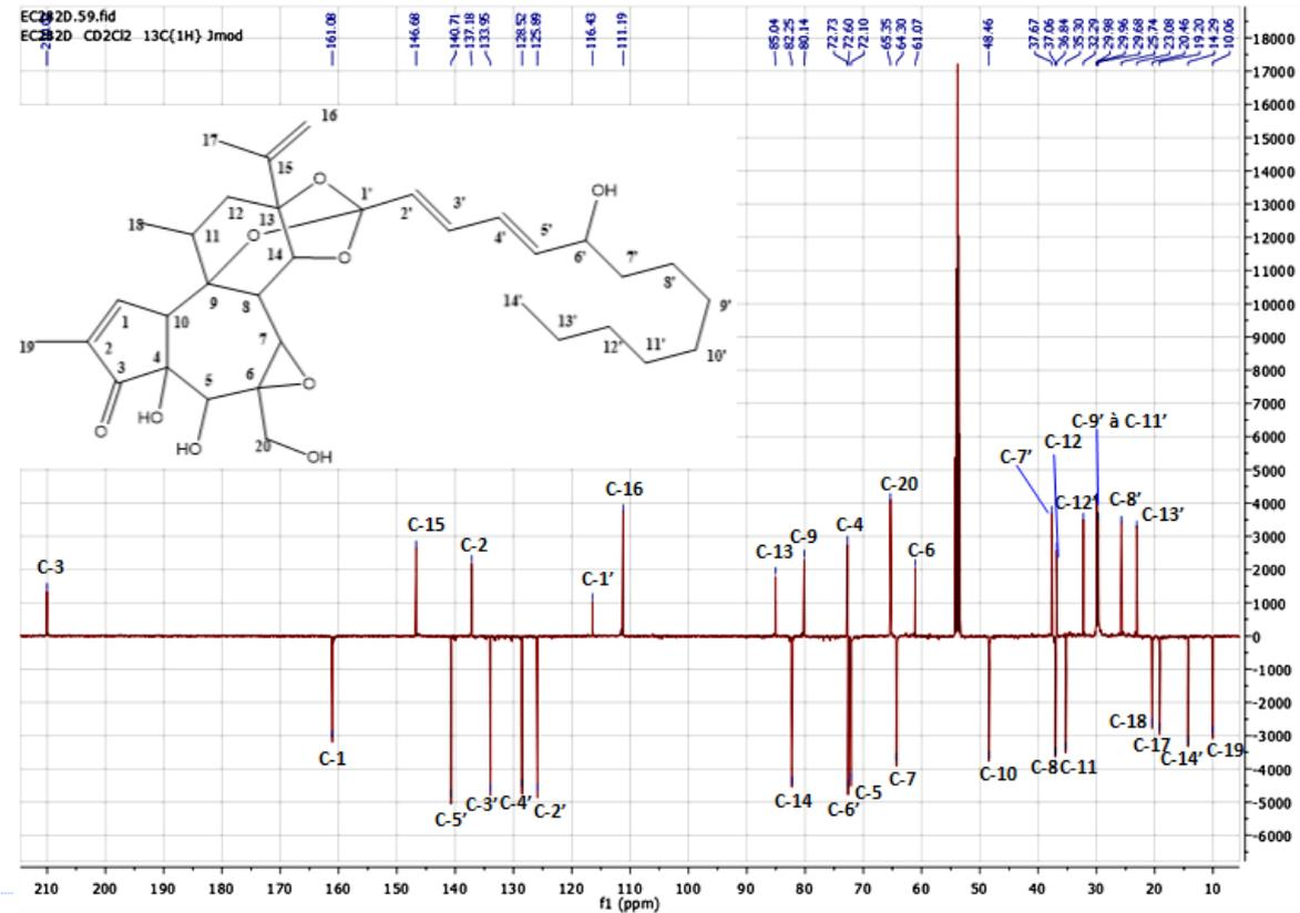
Figure 58: Spectre de RMN <sup>13</sup>C de la molécule M600T4.77 dans le CD<sub>2</sub>Cl<sub>2</sub>
