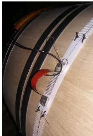
Figure 7-1: Dendromètre installé au niveau du bouge d'une barrique pendant l'élevage d'un vin rouge. Photo Taransaud.
