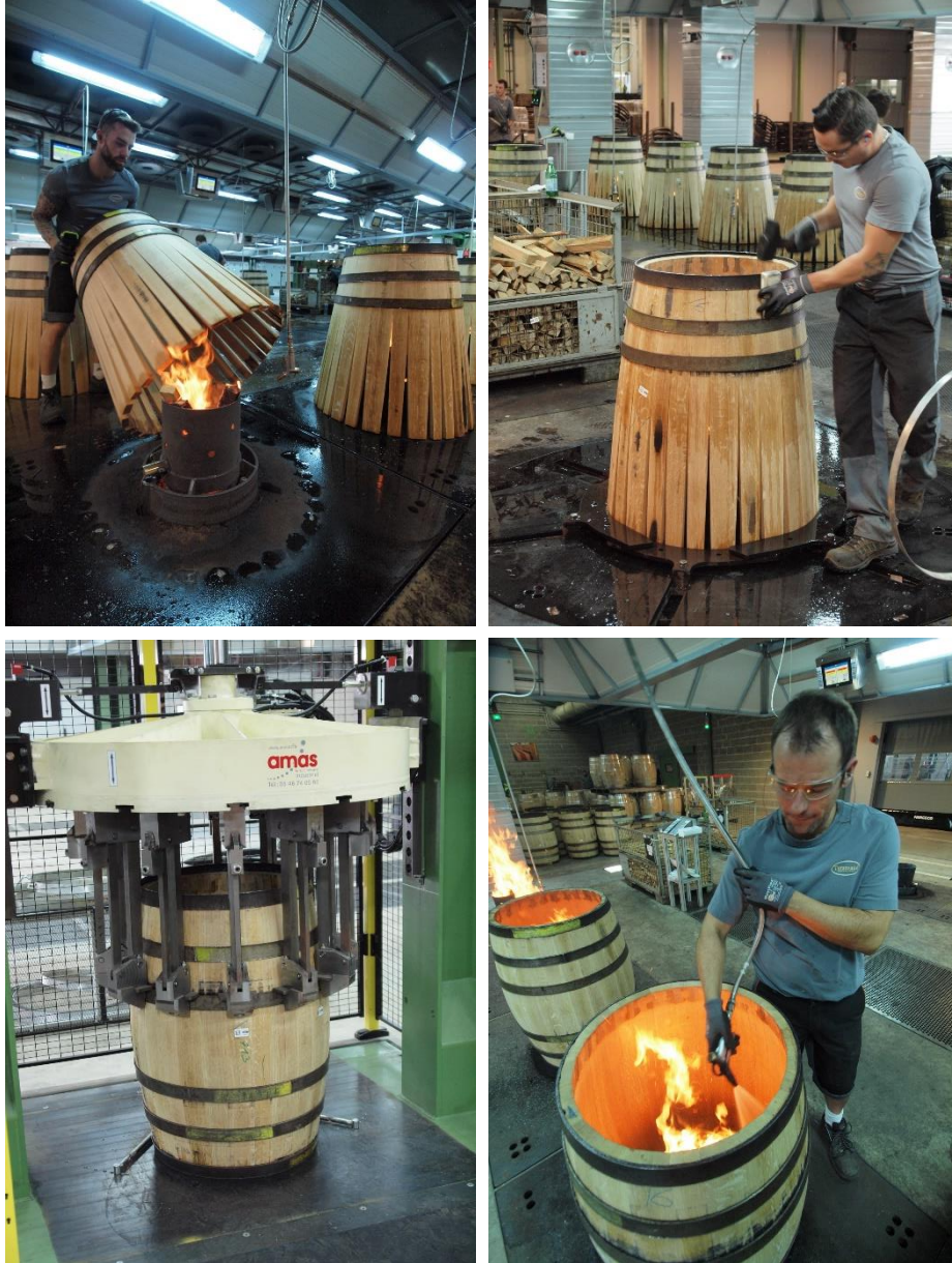
Figure 1-8: Après la mise en rose les barriques sont préchauffées, cintrées puis bousinées. Photos Taransaud.
