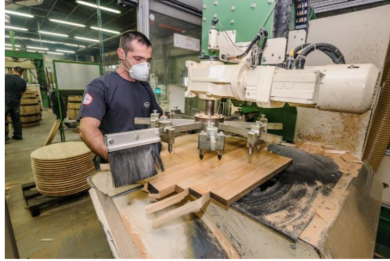
Figure 1-6: Montage de la pièce de fond. Photo Taransaud - Stéphane Charbeau
