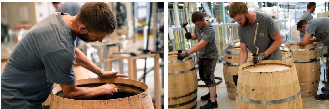
Figure 1-9: Mise en place du fond. Photo Taransaud - Richard Brimer.
