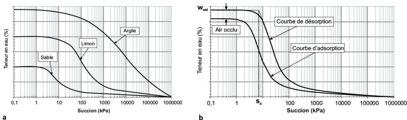
FIGURE 5.4 – Courbes de rétention pour différents types de sol (a) et phénomène d'hystérésis (b).
