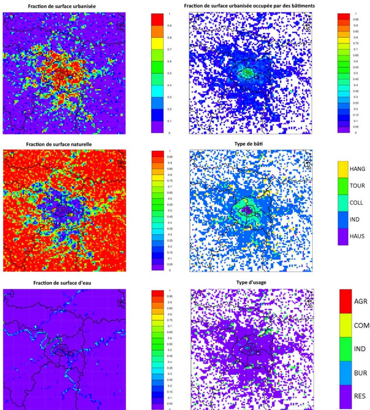
FIGURE C.3 – Cartes représentant au sein de chaque maille de  $1 \text{ km}^2$  du domaine de simulation, la fraction de surface urbanisée, de surface naturelle et d'eau, la fraction de surface urbanisée bâtie et le type de bâti et d'usage correspondant
