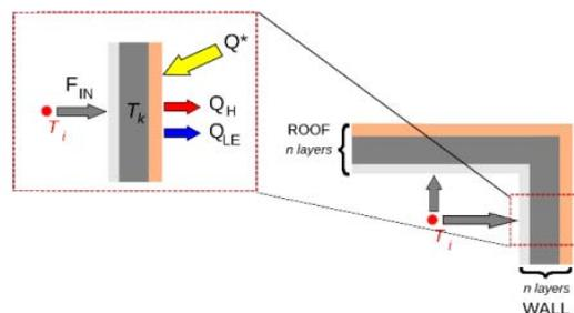
FIGURE 3.4 – Échanges au niveau des parois du bâtiment dans TEB
