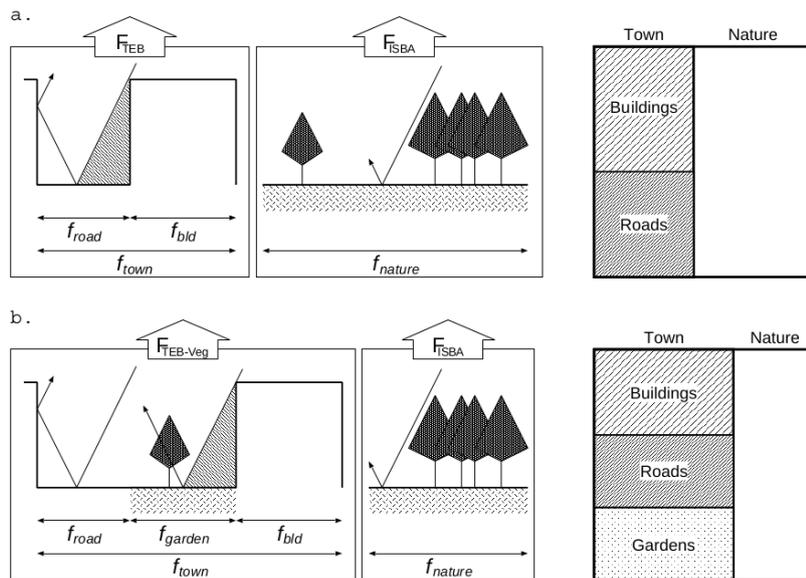
FIGURE 3.6 – Comparaison des configurations TEB-ISBA (haut) et TEB-Veg (bas) pour le calcul des flux de surface par SURFEX en un point où co-existent des surfaces artificielles et naturelles (urbaines et rurales).  $f_{town}$ ,  $f_{bld}$ ,  $f_{road}$ ,  $f_{garden}$ , et  $f_{nature}$  sont respectivement les fractions de ville, bâti, route, jardins urbains, et nature d'une surface d'étude donnée. Source : Lemonsu et al. (2012)
