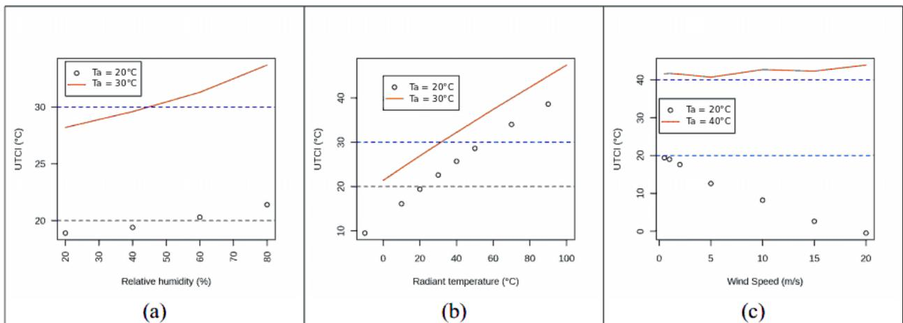
FIGURE 3.15 – Sensibilité de l'UTCI à l'humidité relative (a), la température radiative (b), et la vitesse du vent (c) pour différents régimes de température de l'air. Source Pigeon (2011)
