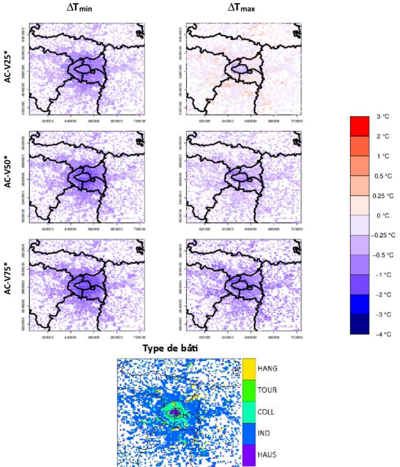
FIGURE 7.4 – Impact des scénarios avec augmentation de la végétation au sol de type pelouse et arbres (AC-V25\*, AC-V50\* et AC-V75\*) sur la température journalière minimale et maximale pour un jour moyen représentatif des 6 jours de canicule 2003. Les différents types de tissus urbains présents dans le domaine sont rappelés dans la carte du bas.
