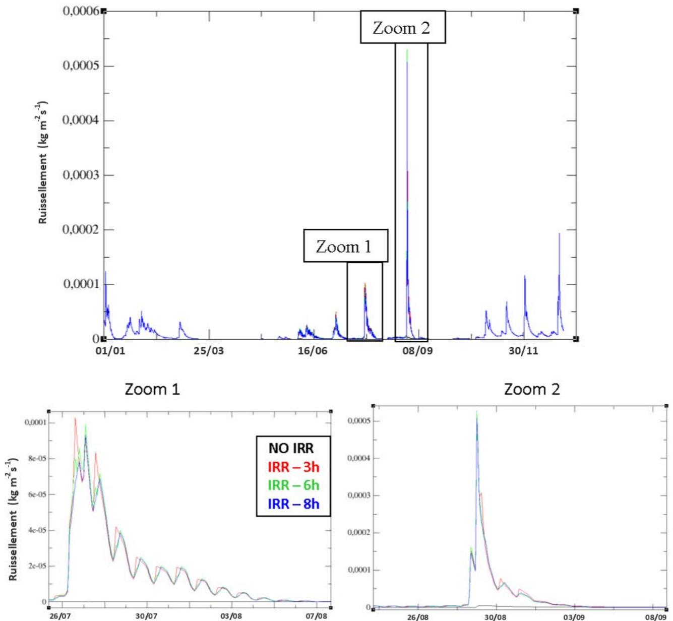
FIGURE 6.11 – Quantités d'eau ruisselées par les TVE simulées pour 2003 (en  $\text{kg m}^{-2} \text{s}^{-1}$ ), sans (NO IRR) et avec irrigation estivale pendant 3 h (IRR-3h), 6 h (IRR-6h) ou 8 h (IRR-8h)
