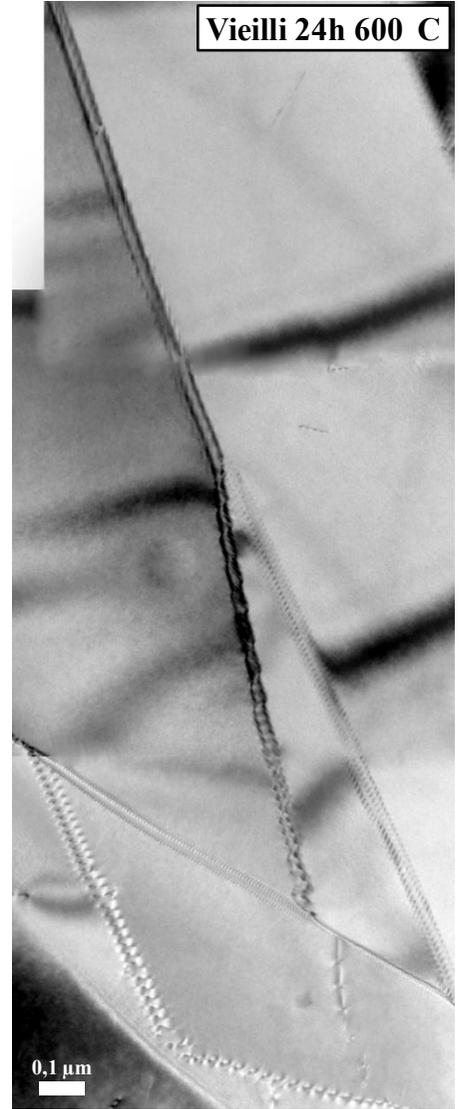
**Figure III.33 - Micrographie en transmission des dislocations dans un grain équiaxe après un vieillissement de 24h à 600°C**
