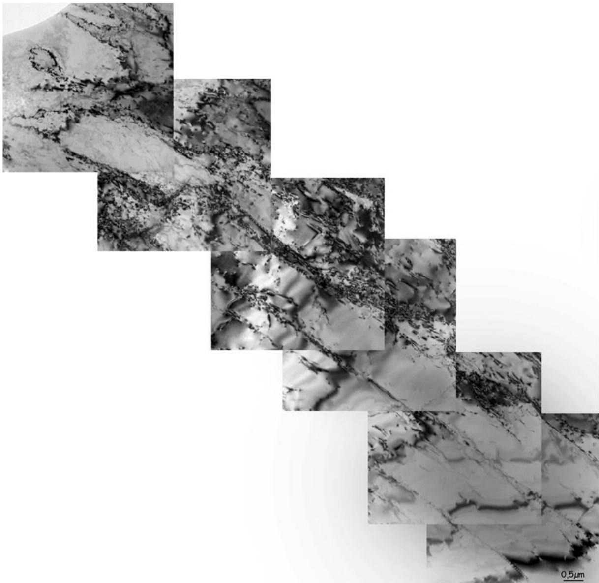
**Figure III.105 - Observation en MET de bandes de déformation dans un grain équiaxe déformé de 5% à 600°C**
