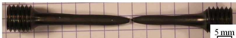
Figure III.42 - Photographie d'une éprouvette après un essai de traction à 600°C présentant une striction diffuse (déformation de toute la zone utile) et plusieurs localisations de déformation dont l'une conduit à la rupture
