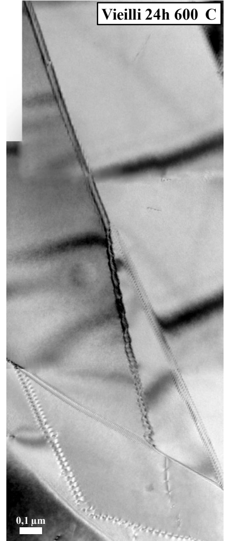
Figure III.33 - Micrographie en transmission des dislocations dans un grain équiaxe après un vieillissement de 24h à 600°C
