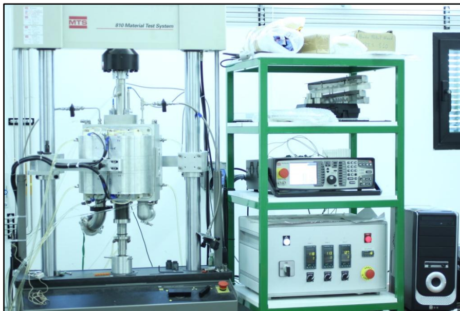
Figure II.10 - Photographie de la machine d'essai située au CIRIMAT : MTS 810 équipée d'un four à lampes
