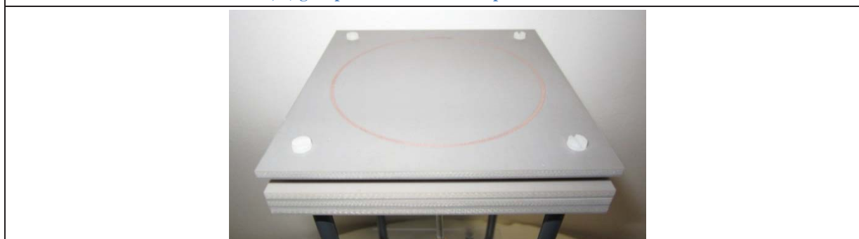
Figure 109 : Photographie de la maquette n°5 : Spirale d'Archimède + 4 anneaux crénelés (N=220)
