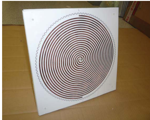
Figure 137 : Antenne spirale miniaturisée par la méthode de réduction des anneaux résonnants. Substrat papier. Diamètre 28cm, 3 anneaux crénelés à 100 motifs. Travaux réalisés par Jérémy Valleau.
