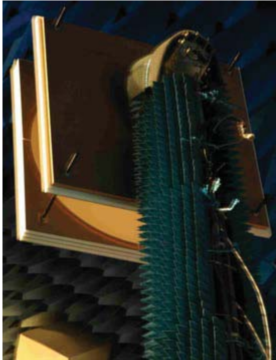
Figure 139 : Photographie de l'antenne VHF fixée sur le mât de la BCMA, vue arrière.
