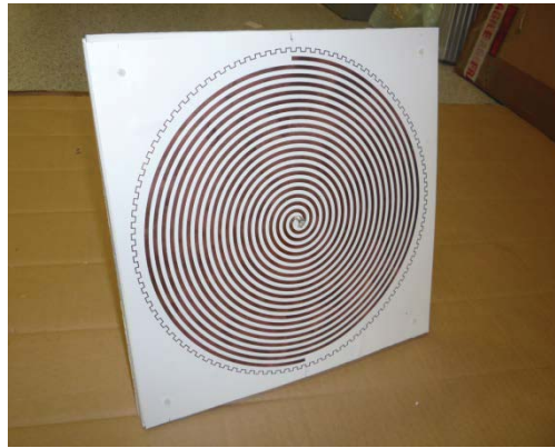
Figure 137 : Antenne spirale miniaturisée par la méthode de réduction des anneaux résonnants. Substrat papier. Diamètre 28cm, 3 anneaux crénelés à 100 motifs. Travaux réalisés par Jérémy Valteau.
