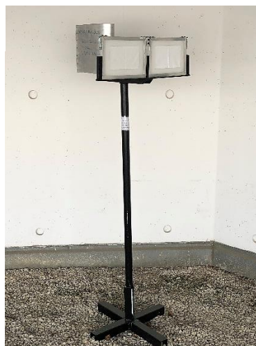
Figure 33 : Photos des dispositifs de prélèvement de poussières (A) girouette placée sur le toit ; (B) capteur à poussière.
