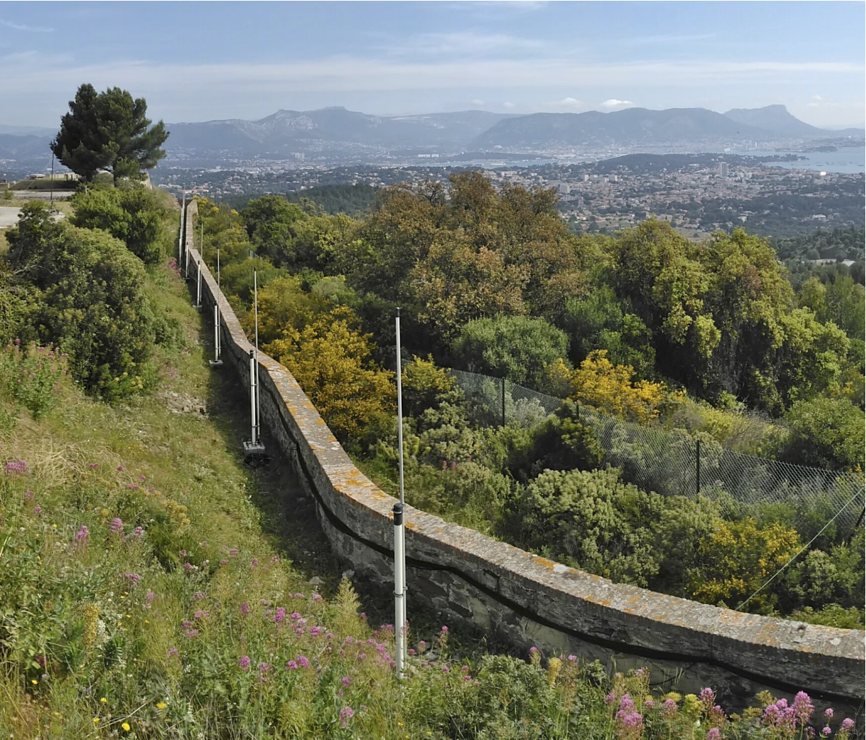
Figure 1: Réseau de réception du Fort Peyras constitué de 12 antennes passives avec 4 antennes passives supplémentaires. Il est situé sur la face Est du massif du cap Sicié près de Toulon
