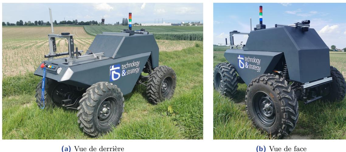
Figure 2.16. – Plate-forme expérimentale KIPP.
