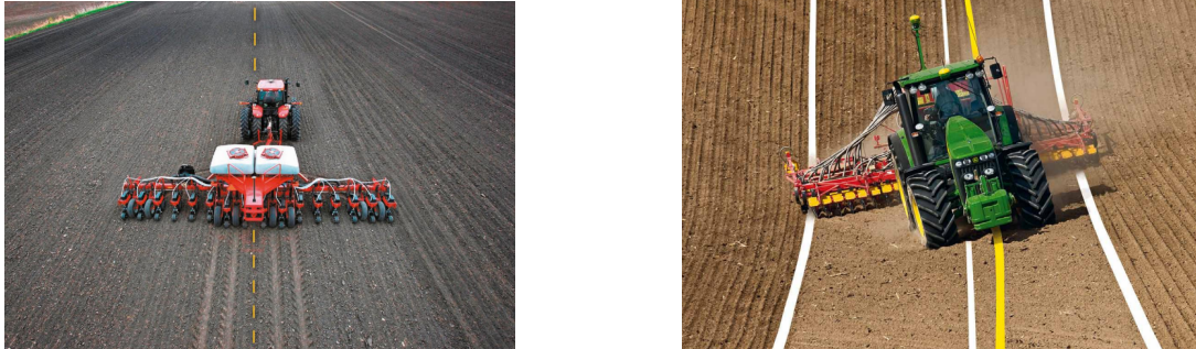
(a) Système TrueGuide passif qui contrôle le tracteur pour positionner l'outil (source : Vantage AM) (b) Décalage du tracteur pour positionner correctement l'outil (source : John Deere)
