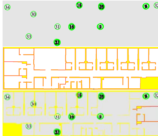
FIGURE 4.1 – Illustration du réseau montrant les positions de 35 nœuds simulés, des cercles superposés représentent un patient portant 5 nœuds capteurs.
