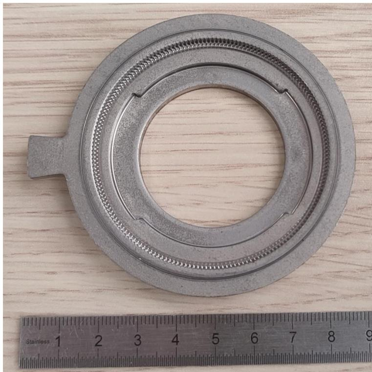
**Figure 3 : Flasque mobile avec micro-denture**
