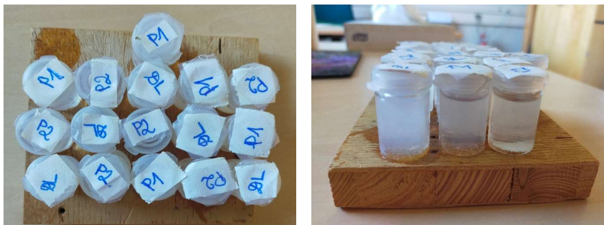
Fig.21 : Vue d'en haut et d'en face du deuxième fantôme de diffusion. 16 bouteilles de 5 mL remplies avec les gels DL*, P1 et P2*, collées de manière aléatoire sur un support en bois.
