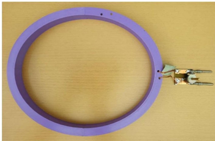
Fig. 10 : Photo de l'antenne circulaire utilisée pour les tests de diffusion avec nos fantômes de diffusion. Source : Réf. [78]
